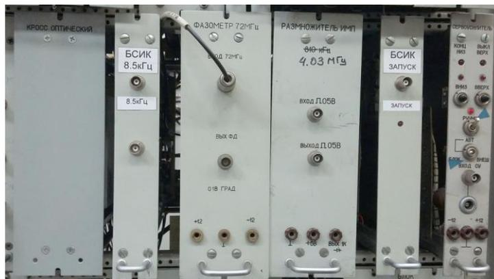
Рисунок 10: Новые блоки синхронизации в РС14 (4 этаж).
