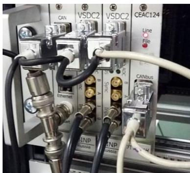
Рисунок 4: Модули для управления одним этажом ГИДов.
