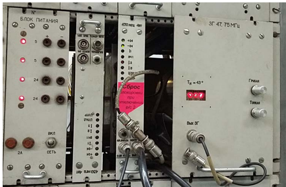
Рисунок 2: Усилитель-умножитель в РС2 в РП. Большая розовая наклейка указывает на кнопку сброса.
