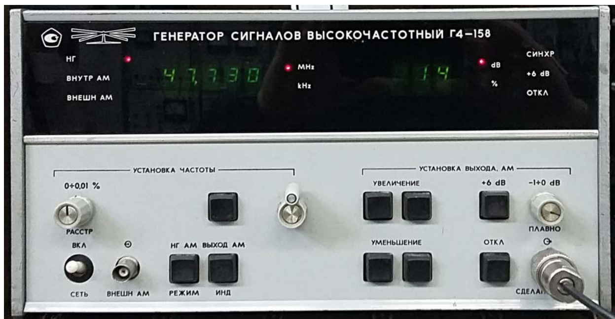
Рисунок 1: Задающий генератор в РСЗ в РП. Правильное состояние индикаторов и настроек.
